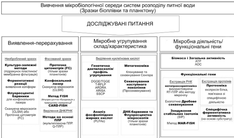
Рис. 1. Схема існуючих методів характеристики мікробних угруповань у системах розподілу питної води
