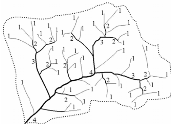
Рис. 1. Структура річкового басейну IV порядку (відповідно до кодування басейнів за Стралером – Філософовим): .... – лінія вододілу, 1–4 – порядки водотоків або ерозійної мережі
